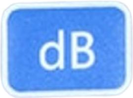
Obturando el botón de dB, podremos realizar la selección de la unidad de medida con la cual deseamos obtener y/o visualizar la medición capturada por el OPM.
